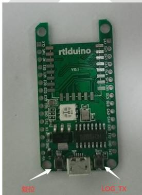
(5) 此时为了检查模块是否处于下载模式可以打开串口工具,波特率 115200,8,N,1，此时用 16 进制显示，如果看到串口如下图一样，不断接收到数据，则表示进入了烧录模式，如果模块打印正常的启动 log，这表示没有进入烧录模式，需要重复上述操作，直到进入烧录模式。
