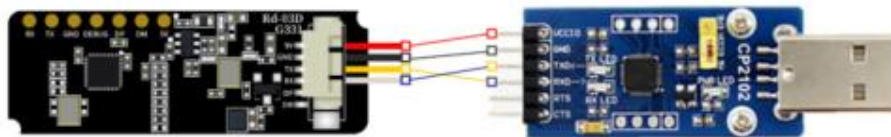
图 1.1 Rd-03D 模组通过右侧排针与串口工具连接
