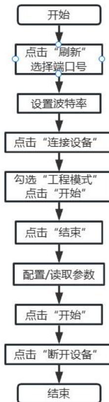
图 7 可视化配置工具操作流程
