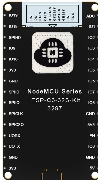
ESP-C3-32S-Kit 管脚示意图
