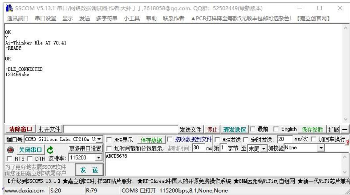
在串口工具中输入 ABCD5678, 点击发送, 手机上也将会收到同样的数据。
