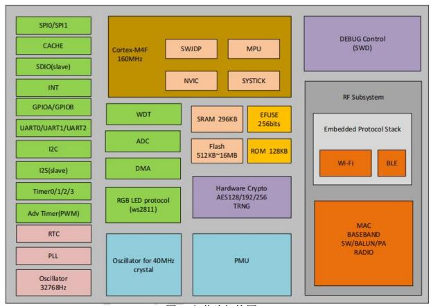
图 1 主芯片架构图
